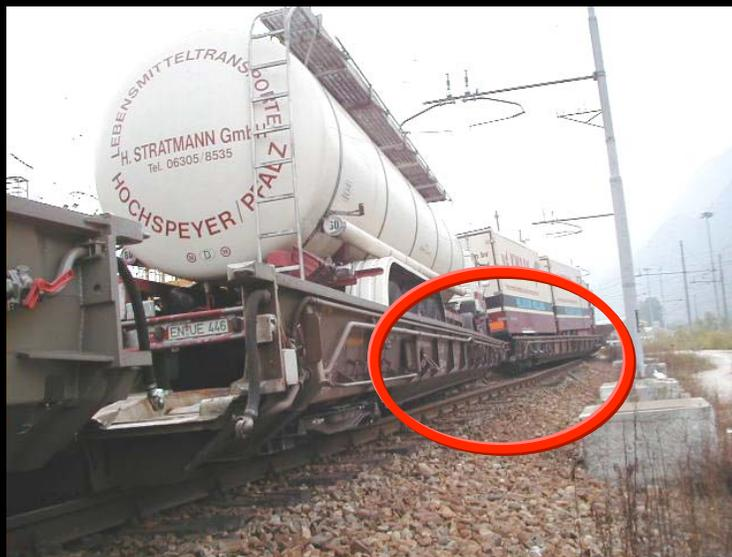
Mangelhafte Fahrzeugkontrolle nach Entgleisung
